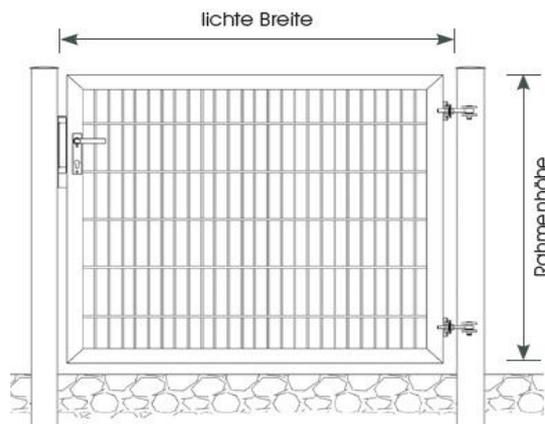
Rahmen: 60 x 40 mm, Torfüllung: **DSM 8/6/8mm** MW 50 x 200 mm, Torbänder M16 (ca. 180°),
